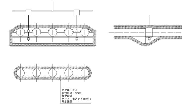
4条管 一般部耐火防護断面図 S=1/10
