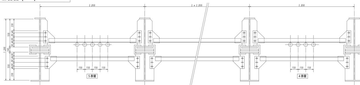
5条管 一般部耐火防護断面図 S=1/10
