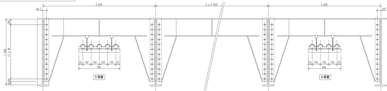
横桁断面図 [S-2] S=1/20
