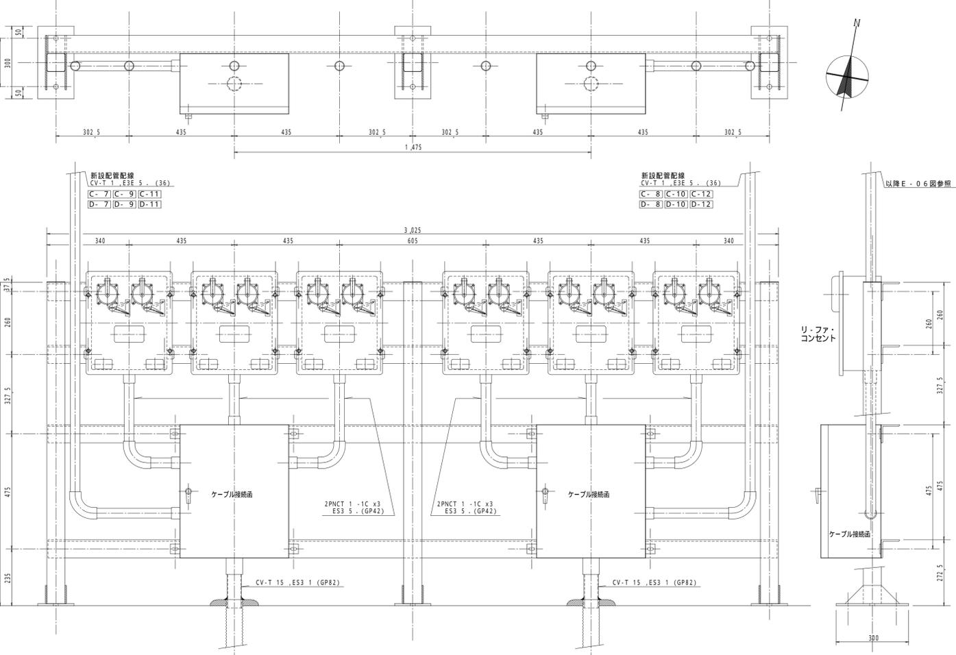
3 リーファ・コンセント取付 詳細図 1/ 10 架台 - Dタイプ
